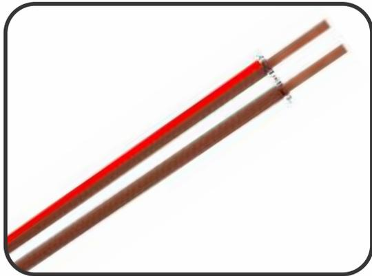
**Características:** Condutores de fios de cobre eletrolítico, têmpera mole, classe de encordoamento 4, isolados em PVC 70°C, transparente com tarja vermelha.
